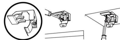
debajo del borde frontal interno del riel: la lengüeta flexible en la parte inferior de cada soporte se engancha en la parte posterior del riel.
