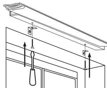
Coloque el riel contra los soportes como se ilustra – centre la cortina sobre la apertura de la ventana – y marque los sitios de cada hoyo de los soportes en el riel. Perfore la tela en las ubicaciones de los agujeros usando la punta de un tornillo, y luego perfore los orificios de los tornillos de los soportes usando una broca de 5/64". Fije la cortina a los soportes usando los tornillos de 3/4" que se incluyen.
