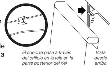
4. Posicione la cortina de manera que la parte frontal-inferior de cada soporte pasa a través de los hoyos en la tela en la parte posterior del riel. Pida ayuda si fuese necesario, aunque una sola persona puede lograrlo. Deslice el riel enteramente en los soportes.
