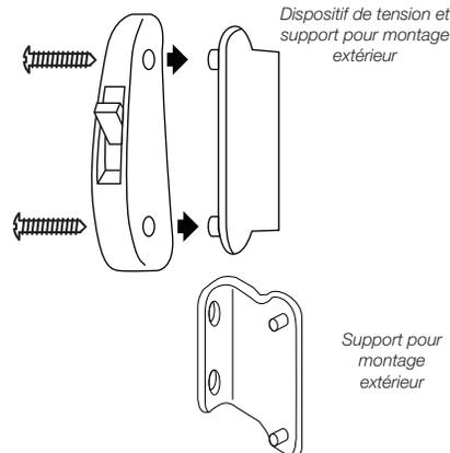
Dispositif de tension et support pour montage extérieur
