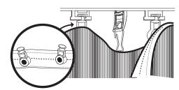
du panneau, qui doit être fixé à l'enrouleur de flambage à l'extrémité du rail. L'utilisation de pinces est recommandée car la bobine et l'attache de rail sont trop serrées - enroulez du ruban adhésif autour des mâchoires des pinces pour éviter d'endommager le tissu. Séquentiellement, clipsez chaque clip d'un rail à l'autre.
