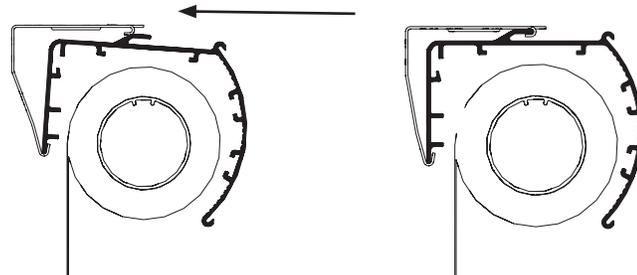
Enclenchez le rail en place en faisant glisser la fente à l'arrière du rail vers le bas du support de montage. Poussez vers l'avant et vers le haut, en enclenchant le rail sur le haut du support de montage.
