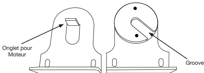
Notez que le support pour l'extrémité où va le moteur a une languette qui s'insère dans le boîtier du moteur. Le porte-épingle à l'extrémité a une fente où la broche glisse.
